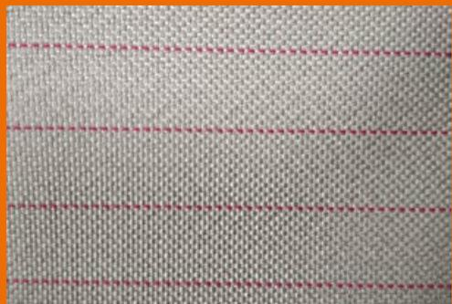
Создаётся из Е-стекла с проволочным плетением из нержавеющей стали и покрыто слоем полиуретана. Благодаря высокой плотности, армированию и специальному плетению, используется для производства противопожарных штор большого размера(премиум).
