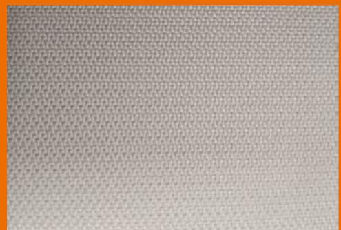
Высококачественный термо- и огнестойкий материал для изготовления дымозащитных экранов и штор.
